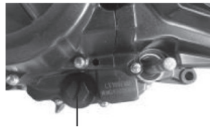
Tapón de drenaje
